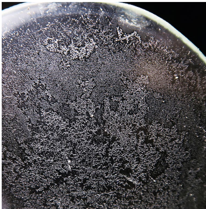
Il. 5. Fragment szkła wyjętego z miniatury MNK III-min-841 z widocznymi wykwitami na powierzchni, fot. Z. Maniakowska-Jazownik
